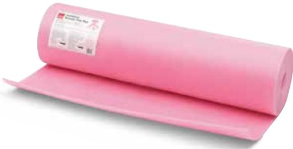
La membrane insonorisante Quiétude<sup>MD</sup> pour planchers de Owens Corning<sup>MD</sup> est fabriquée avec du polyéthylène léger, à alvéoles fermées. Elle est conçue expressément pour isoler les vibrations sonores et les bruits d'impact dans un système de revêtement de sol. La membrane insonorisante Quiétude<sup>MD</sup> pour planchers est conçue pour être installée entre le sous-plancher de bois ou de béton et un revêtement en panneau de contreplaqué, en béton de plâtre ou en béton.
