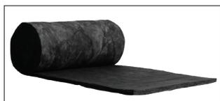
**Matelas acoustique noir SelectSound<sup>MD</sup>** : Il est fait de fibres de verre inorganiques et d'un liant à base de résine thermodurcissable et est formé en matelas flexibles. Il est stable du point de vue dimensionnel et il ne rétrécit pas et ne gauchit pas. Il convient parfaitement dans les cas où l'on désire supprimer les reflets lumineux tout en assurant une performance acoustique exceptionnelle.
