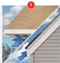
Aident à prévenir l'accumulation de chaleur et d'humidité dans le grenier en permettant à l'air frais extérieur de pénétrer dans le grenier.
