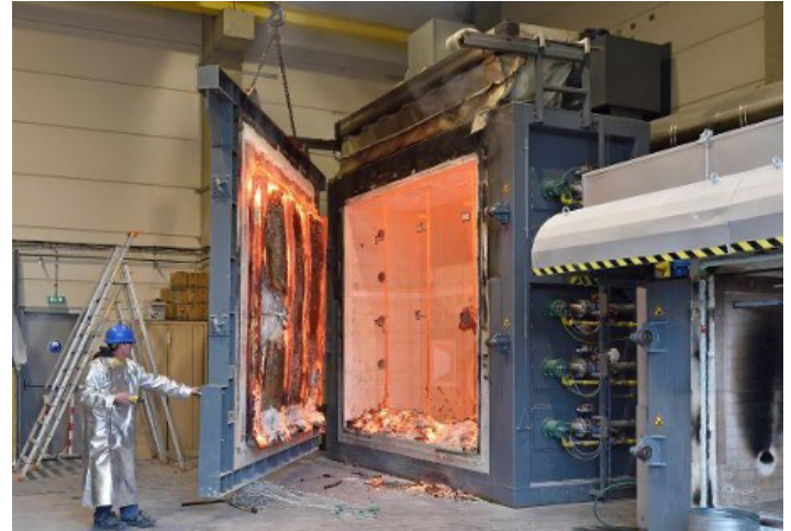
ASTM E119 Vertical Furnace
