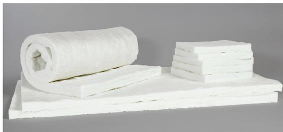
Los productos de aislamiento del sistema ThermoRange® (TRS) de Owens Corning son fieltros flexibles blancos de fibras de vidrio inorgánicas aglutinadas con una resina termosolidificante patentada. TRS ha sido diseñado para proporcionar excelentes propiedades de manipulación y estabilidad dimensional durante la instalación en las instalaciones del fabricante (OEM) y para generar poco humo y olor durante el ciclo de autolimpieza inicial de las cocinas.
